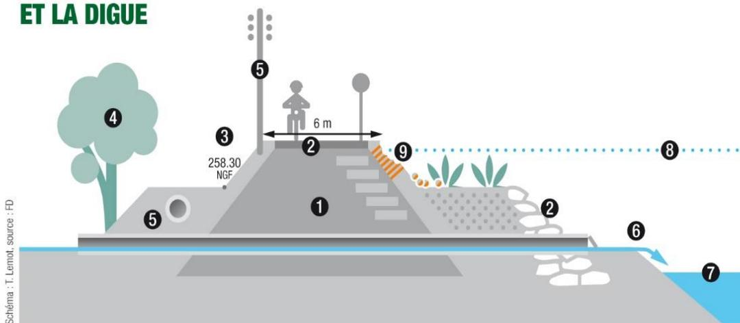
➔ **Données traitées par le logiciel :** ① la structure interne de la digue ② sa structure externe ③ sa géométrie ④ la végétation ⑤ la voirie et les réseaux ⑥ la berge ⑦ le lit ⑧ le niveau d'eau, simulé ou observé ⑨ les désordres.
