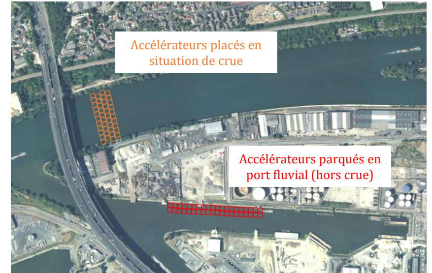
Exemple d'un essaim d'accélérateurs en position de lutte contre les crues et parqués dans un port fluvial (Gennevilliers)
