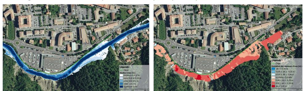
Etat initial de la modélisation hydraulique pour une crue cinquantennale et comparaison avec la situation pénalisante en termes d'exhaussement du lit
