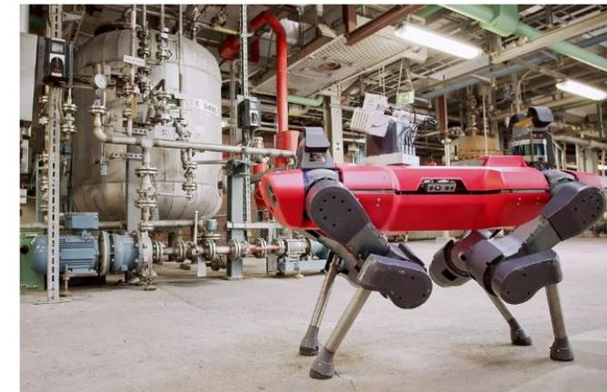
Les robots d'ANYbotics utilisés par BASF pour l'inspection d'une usine de Ludwigshafen
