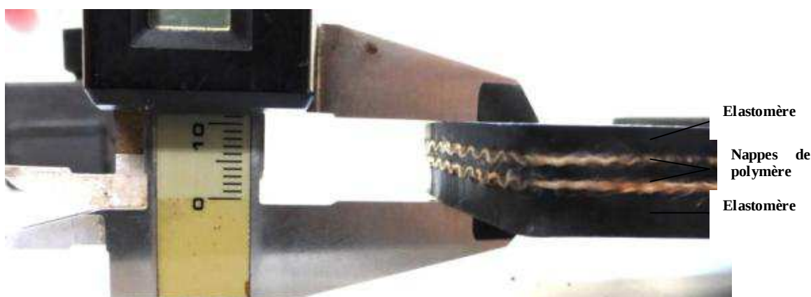
Figure 4 : membrane deux plis polyamide et EPDM [crédit image © J.Aubonnet]
