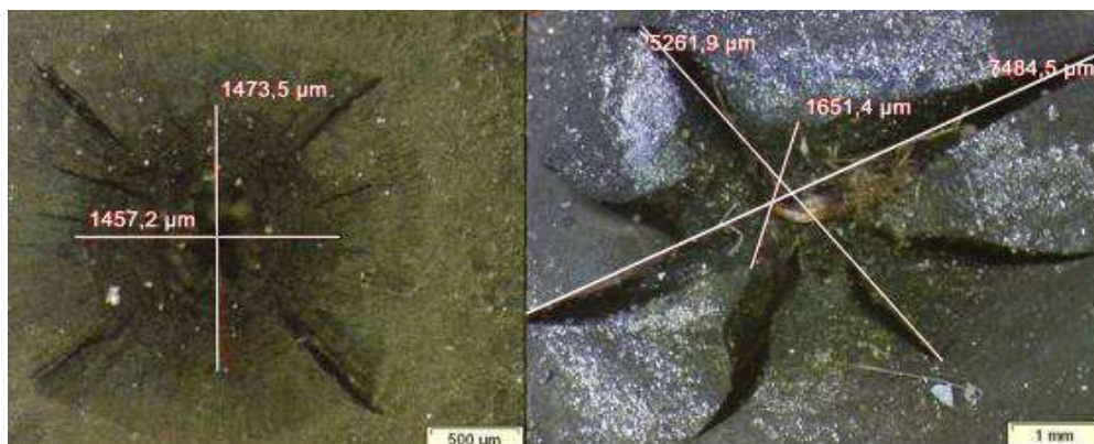
Figure 6 : Mesure de l'impact de Winchester calibre .308 sur une membrane face extérieure/face intérieure [7]
