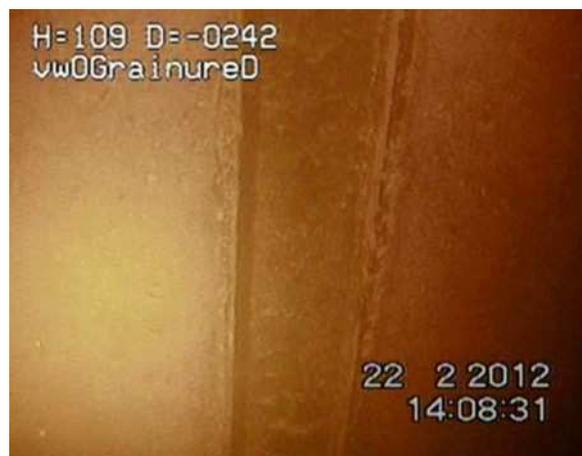
exemples de défaut sur une conduite (corrosion feuilletante)
