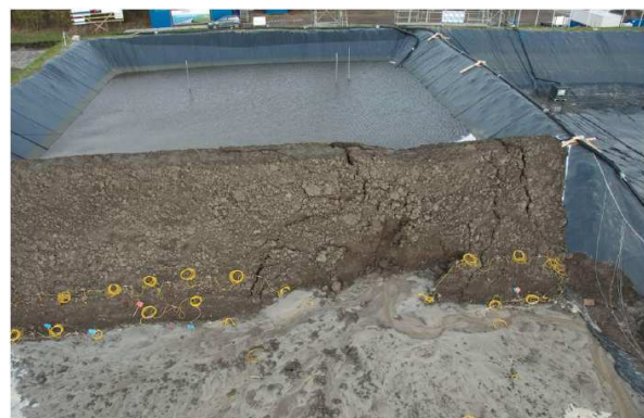
Figure 6 : Fin de l'essai n°2 avec le début de la formation d'une brèche (photo Deltares)
