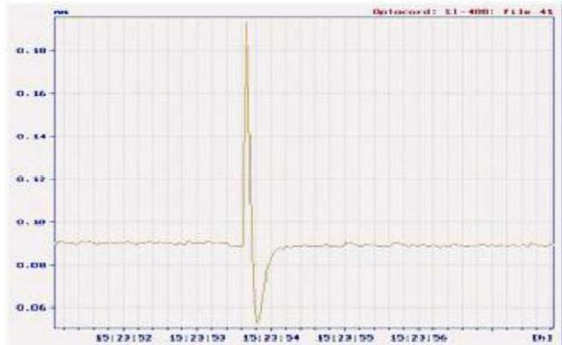
Signature dynamique caractéristique de la rupture d'un fil de précontrainte
