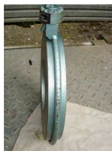
Figure 8 : cellule hydraulique manufacturée par la société Glötzl - 1 cellule de charge - 2 enceinte hydraulique - 3 tirant - 4 plaque de répartition - 5 manomètre - 6 capot
