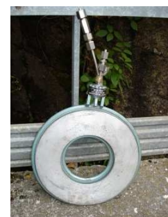
Figure 8 : cellule hydraulique manufacturée par la société Glötzl - 1 cellule de charge - 2 enceinte hydraulique - 3 tirant - 4 plaque de répartition - 5 manomètre - 6 capot
