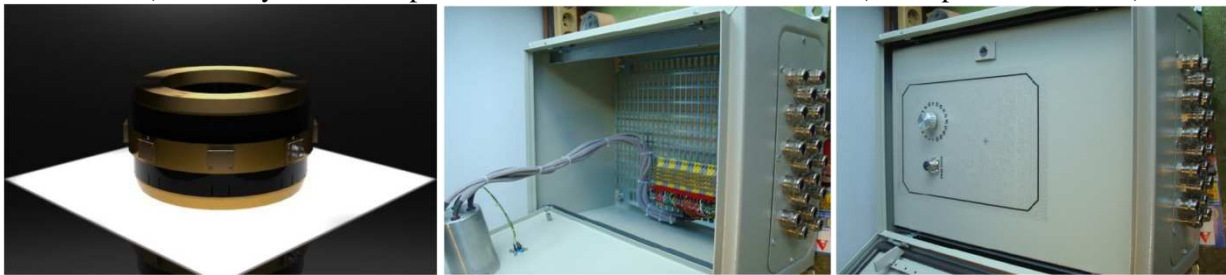
Figure 7 : cellule CV8 manufacturée par GéoInstrumentation et Boîtier Coffret de Raccordement (avec bouton rotatif de sélection)
