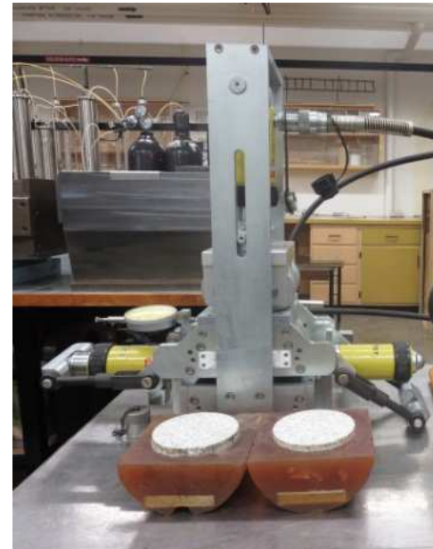
Appareil de cisaillement portatif (Laboratoire et chantier)
