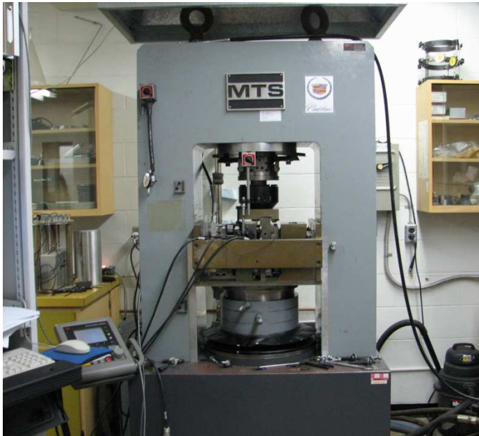
Bâti de cisaillement à l'intérieur du cadre d'une presse MTS
