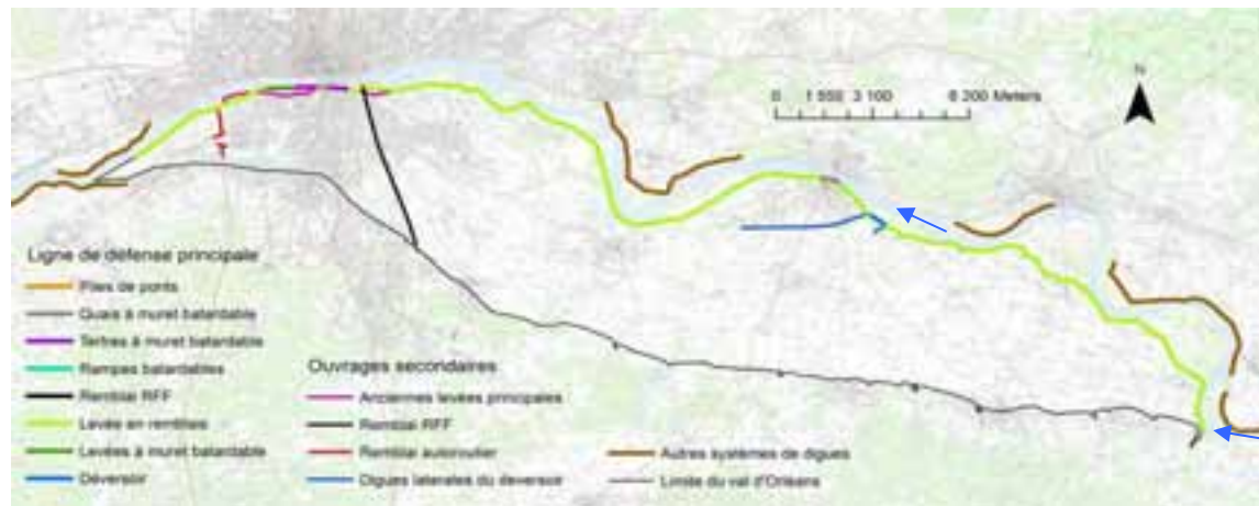
Figure 10 : Les différents types d'ouvrages composant le système d'endiguement d'Orléans
