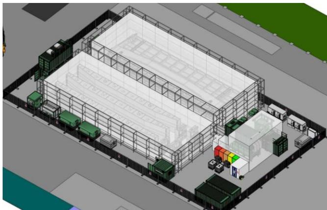
Figure 9 Représentation du sas tel que représenté dans le plan de retrait amiante
