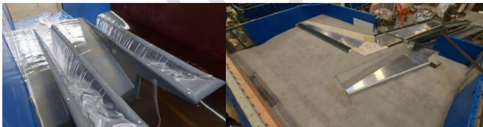
Figure 20 – Modèles physiques du système d'évacuation des crues – Barrage E
