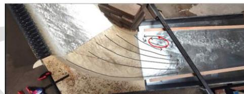
Figure 22 – Zone de recirculation en début de coursier – Evacuateur – Barrage E
