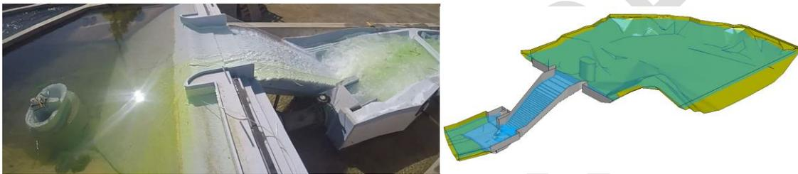
Figure 12 – Modèle physique et hydraulique 3D de l'évacuateur projeté – Barrage D
