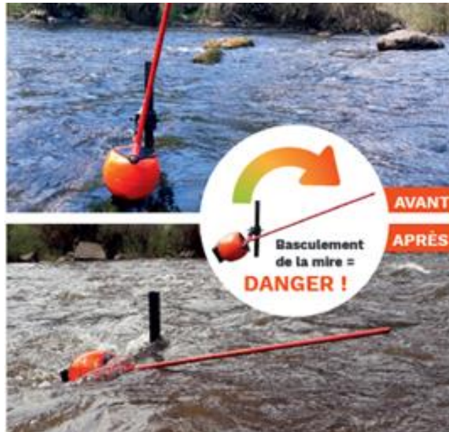
Figure 6 : Dispositif d'alerte visuelle de la montée des eaux
