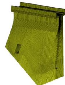
Figure 7 - Visualisation du maillage – plot central – Barrage B
