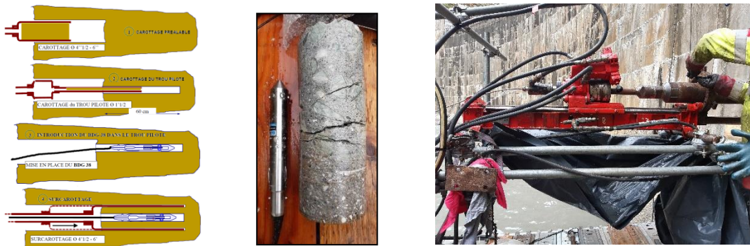
Figure 1 : Principe de la mesure de surcarottage avec cellule Doorstopper
