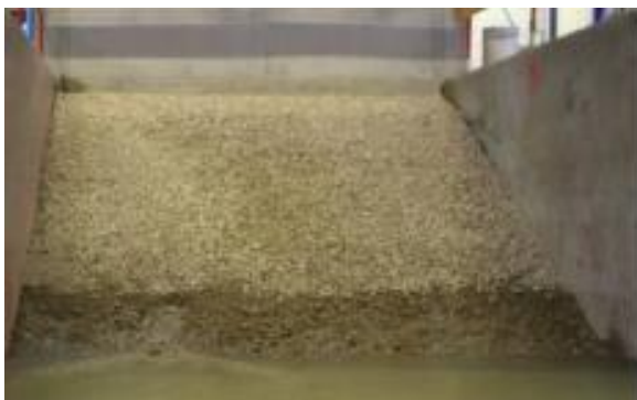
Figure 10 : Présentation de la maquette érosion de digue
