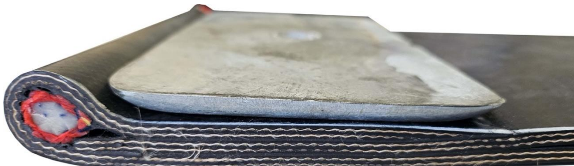
Fermeture ralingue avec complexe 2 plis et plaque de bridage
