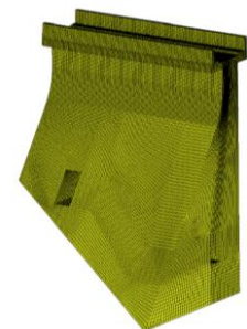
Figure 7 - Visualisation du maillage – plot central – Barrage B
