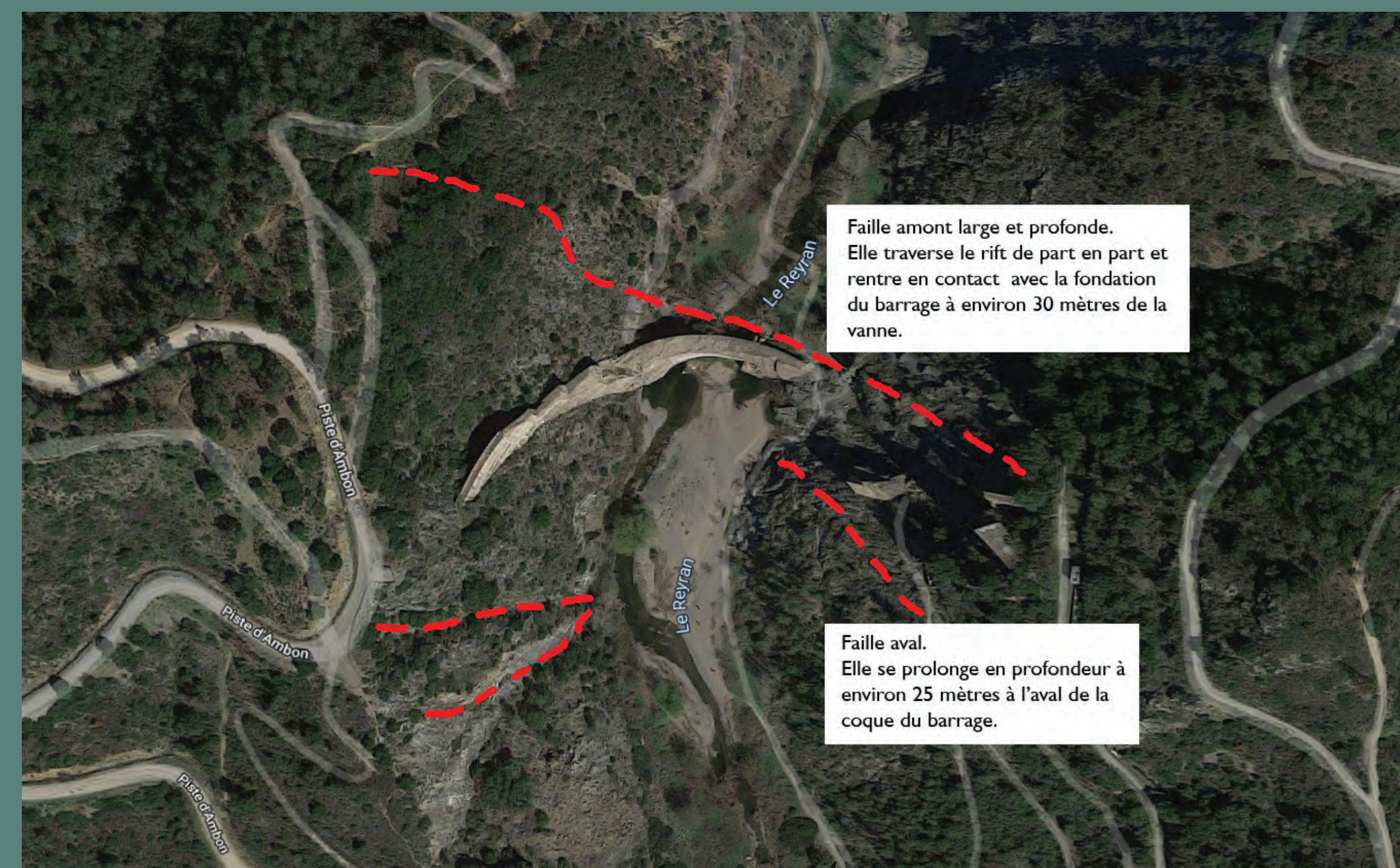
Vue aérienne du barrage et présence des principales failles (Schéma de G. Castanier et JM. Masset, ingénieurs géologues).
