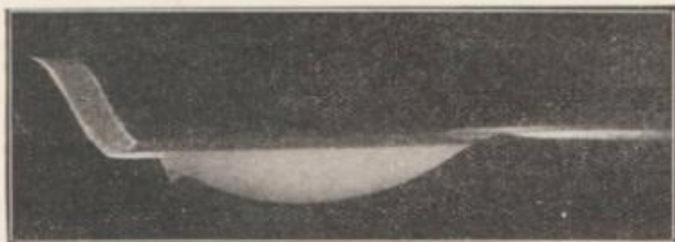
FIG. 2a. — Contre-pente 0, débit 3400 m 3 /sec. Fond de sable. On remarque l'affouillement produit au pied du barrage.
