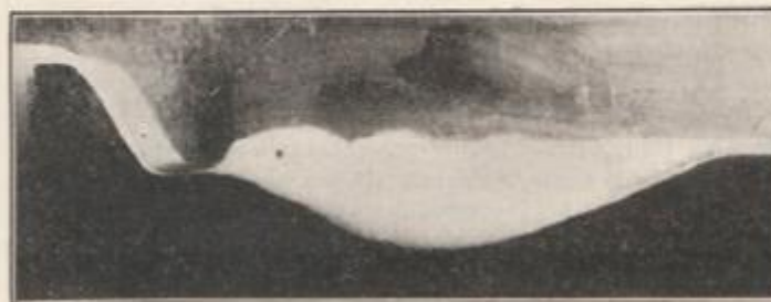
FIG. 2d. — Contre-pente 1/12, débit 2030 m 3 /sec. Fond de sable. Le pied de l'ouvrage est ici remblayé.
