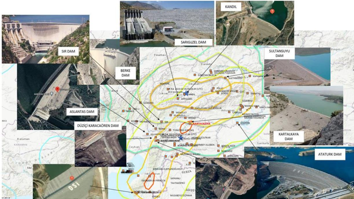
Figure 5 - Localisation des principaux barrages par rapport aux cartes d'accélération estimées par l'USGS pour les séismes de Pazarcik et d'Elbistan [25]
