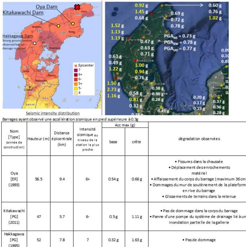
Figure 12 - Localisation des 3 barrages ayant observé plus de 0.3g en pied - accélération des stations de la péninsule de Noto - synthèse des observations faites suite au séisme par le Bureau de la gestion de l'eau [26]
