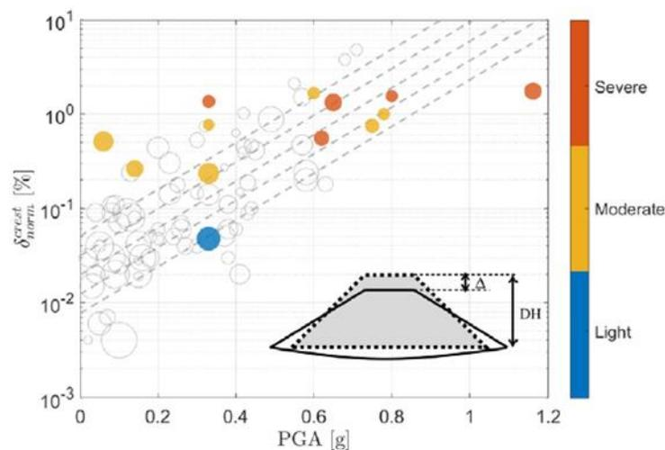
Figure 9 - Tassements relatifs à la taille des barrage, mesurés à la suite des séismes turc – comparaison aux données tirées d'autres ouvrages du REX international [29]
