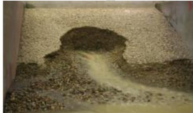
Figure 10 : Présentation de la maquette érosion de digue
