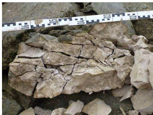
Photo 2 : Constat de gélivité d'une fraction d'enrochement
