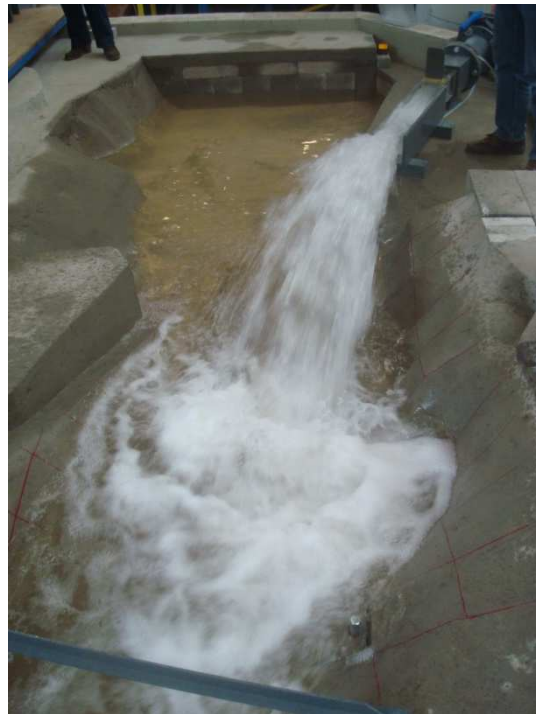
Graphique 4 : Modèle réduit, détail de la cuillère et essai
