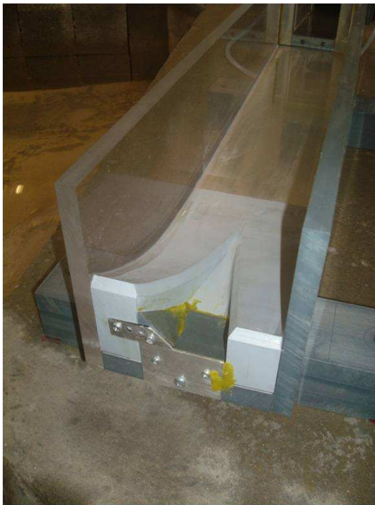
Graphique 4 : Modèle réduit, détail de la cuillère et essai
