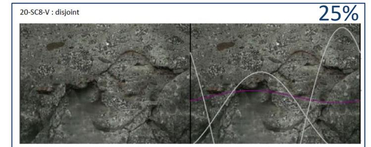
*Exemples d'imageries de parois au contact béton-rocher : contact collé, partiellement collé et disjoint*
