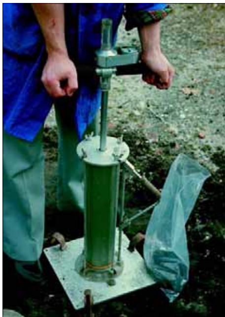
▲ 4 - Contrôle de compactage au densitomètre à membrane...
