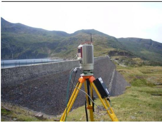
Figure 3: scanner laser stationné sur trépied
