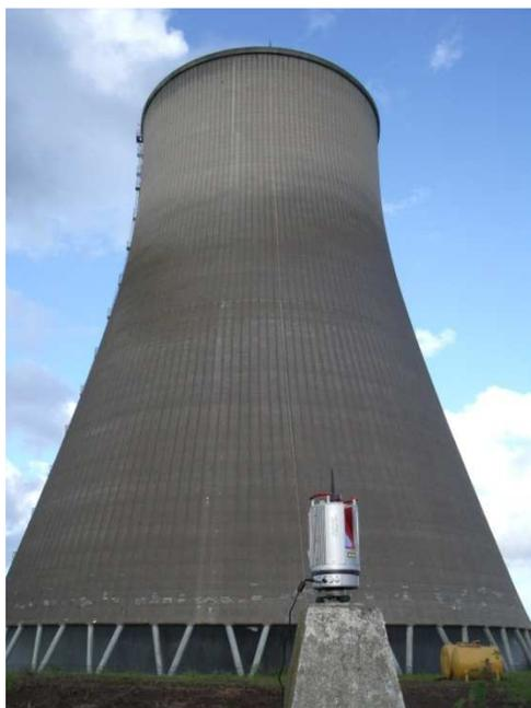
*Figure 1: Scanner laser stationné sur pilier d'auscultation pour la mesure lasergrammétrique d'un aéroréfrigérant*
