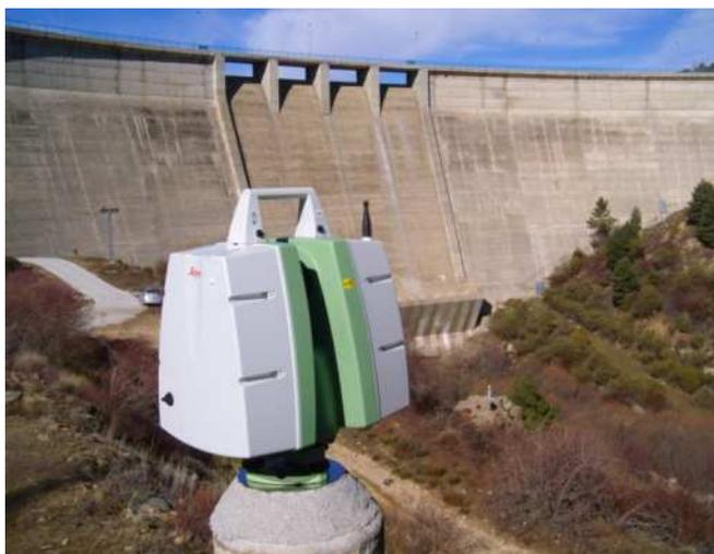
*Figure 7 : Leica C10 sur son pilier géodésique.*
