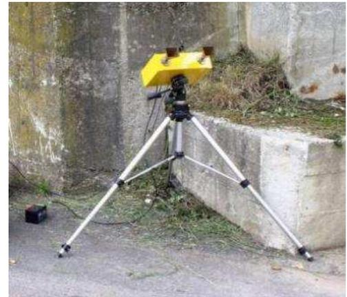
*Figure 15 : Deux exemples de radars interférométriques disponibles commercialement. (Photos Groundprobe et IDS)*
