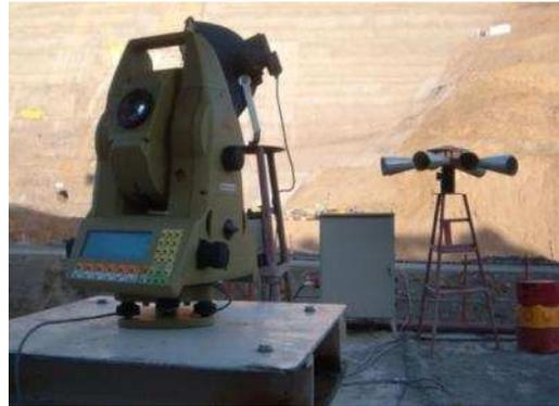
Figure 1 : Photos du barrage de Koudiat Acerdoune en construction avec le système CYCLOPS et sa sirène.
