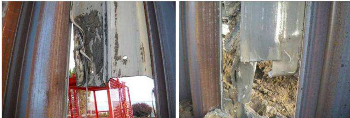
*Photos 5 et 6 : Paires de palplanches PU32 déchirées après battage et extraction de la zone indurée*
